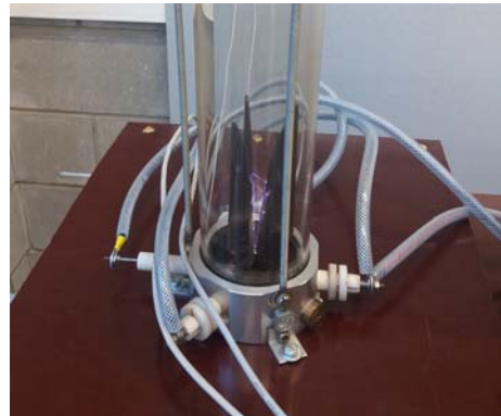
Rys.3. Widok na wyładowanie w komorze reaktora, w obszarze elektrod zapłonowych, nadmuch 6l/min
