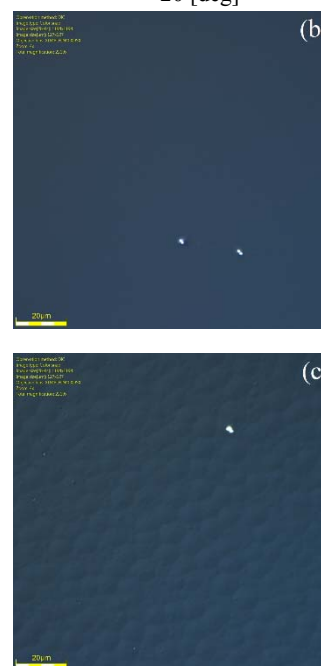
Rys.4. Dyfraktogram (a) i obraz powierzchni sl #55 z 30 periodami z zaniedbywalnie cienkimi IFs InSb (b) oraz obraz powierzchni struktury fotorezystora #195 bez defektów punktowych (c)
