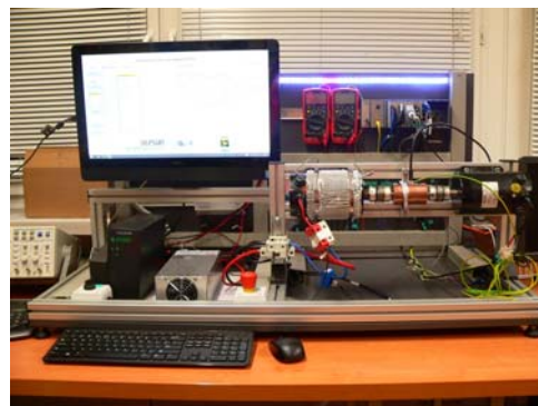
Rys. 2. Schemat poglądowy stanowiska badawczego zwanego Hamownią
