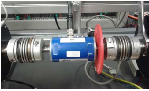
Rys.4. Montaż czujnika momentu na stacjonarnym stanowisku badawczym
