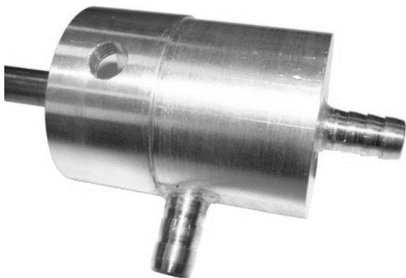
Rys. 3. Końcówka do podłączenia obiegu cieczy chłodzącej
