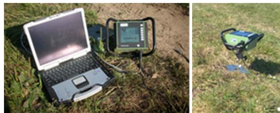
Rys. 3. Penetrologger Eijkelkamp z sondą ThetaProbe
