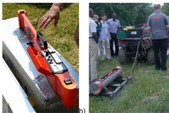
Rys. 1. Konduktometr EM38 (a) i sposób jego transportowania podczas pomiarów na polu (b)
