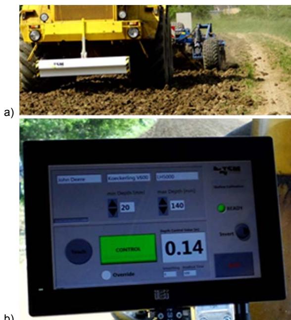
Rys. 2. Zmienna uprawa gleby na podstawie wskazań urządzenia Top Soil Mapper: a) skaner Top Soil Mapper, b) panel sterujący głębokością pracy narzędzia
