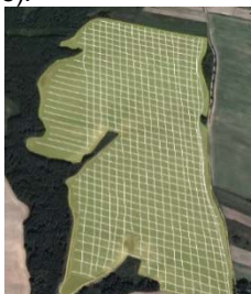
Rys. 2. Schemat prowadzenia narzędzia wzorcowego oraz sondy EM38 po powierzchni poligonu doświadczalnego
