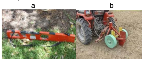
Rys. 1. Pomiar: a - przewodności elektrycznej sondą EM38, b - oporu roboczego narzędzia wzorcowego
