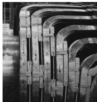
Rys. 1. Widok czoł uzwojenia wzbudzenia fabrycznego generatora
