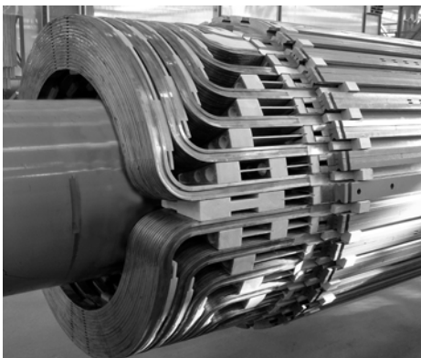
Rys. 5. Widok wirnika i czoła uzwojenia wzbudzenia generatora
