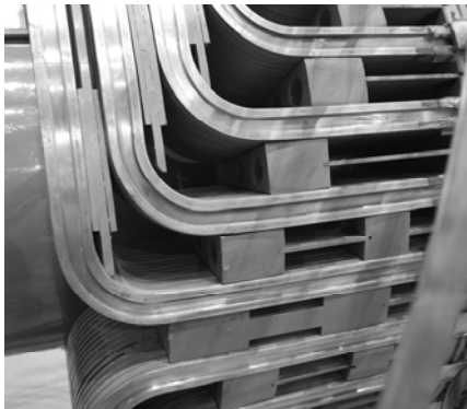
Rys. 9. Czoła cewek uzwojenia wzbudzenia zmodernizowanego generatora
