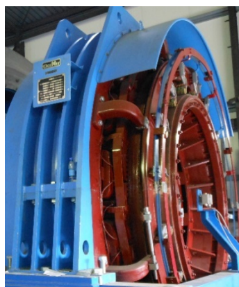
Rys. 1. Silnik wyciągowy serii PW produkcji DFME
