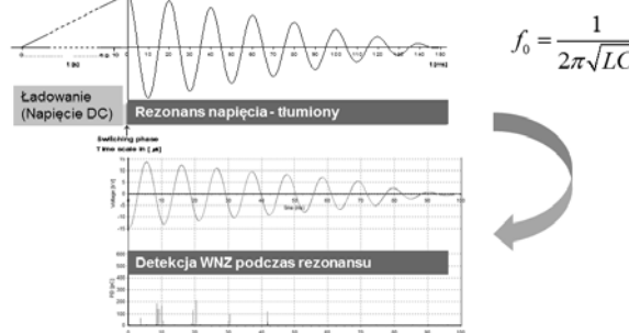
Rys.8. Fala oscylacyjno-tłumiona dla diagnostyki WNZ [4]
