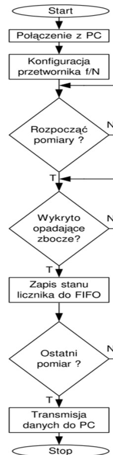
Rys. 2. Algorytm aplikacji przetwornika f/N realizowany w strukturze FPGA
