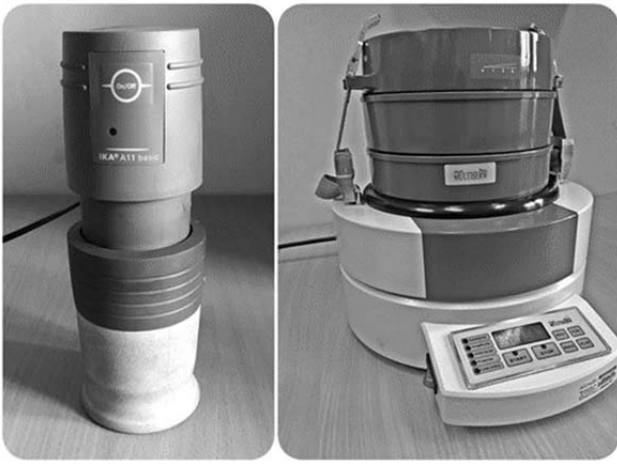
Rys. 5. a) Laboratoryjny młynek szybkoobrotowy IKA® A11 basic, b) Wstrząsarka laboratoryjna Morek MULTISIEW LpzE-2e
