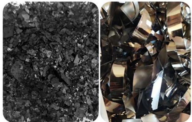
Rys. 3. Materiały odpadowe: a) zendra w płatkach o średnicy około 5 mm, b) taśma nanokrystaliczna o szerokości 10 mm
