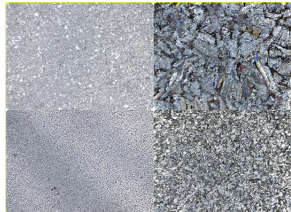
Rys. 7. Powierzchnia przygotowanych próbek materiałów kompozytowych a) zendra 95% + PVC 5%, b) żelazo 2 mm c) żelazo 50-100 µm d) 1% żywicy fenolowo-akrylowej + 99% nanokrystalik 250 µm
