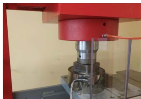
Rys. 3. Stanowisko do wyprasowywania próbek
