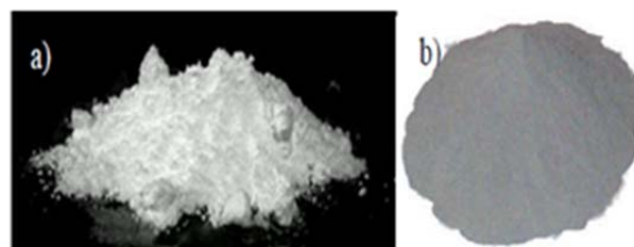
Rys. 2. Materiały składowe kompozytu a) PVC-S, b) proszek żelaza
