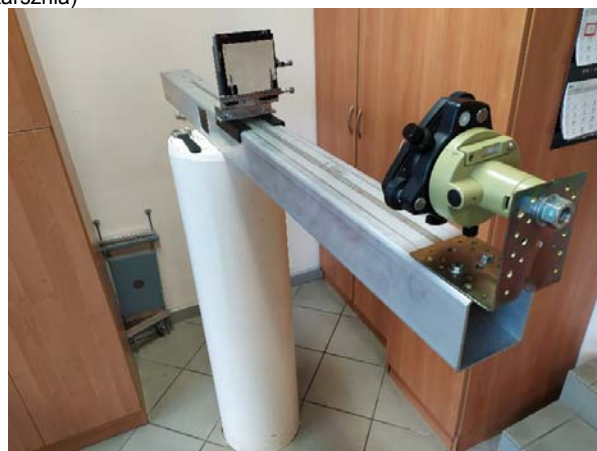
Rys.4. Widok stanowiska laboratoryjnego testowania spodarkowych pionów instrumentów geodezyjnych (fot. Krzysztof Karsznia)
