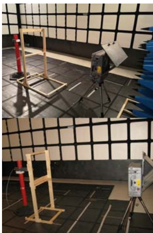
Rys. 10. Widok stanowiska laboratoryjnego do pomiaru absorpcji badanego materiału z generatorem posiadającym reflektor dla pomiaru referencyjnego
