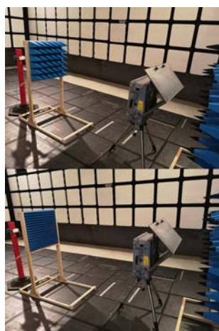
Rys. 11. Widok stanowiska laboratoryjnego do pomiaru absorpcji badanego materiału z generatorem posiadającym reflektor dla pomiaru zasadniczego
