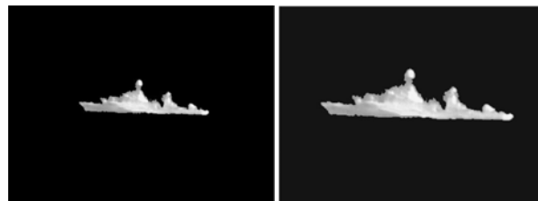
Rys.4. Iloczyn obrazu binarnego i obrazu w skali szarości oraz obraz po wykonaniu operacji normalizacji wysokości sylwetki i centrowania
