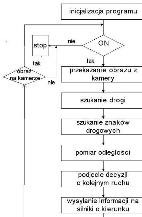
Rys. 4. Algorytm zaimplementowanej logiki
