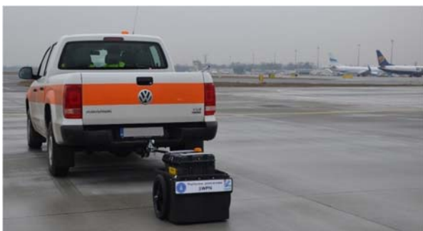
Rys. 1. Platforma pomiarowa do badania jakości działania lamp lotniskowych [1]
