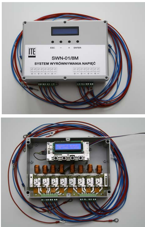
Rys.3. Praktyczna realizacja prototypu systemu wyrównywania napięć na ośmiu 12 V akumulatorach ołowiowych pracujących w połączeniu szeregowym typu SWN-01/8M w wersji wyposażonej w mikroprocesorową funkcję monitorowania i nadzoru.
