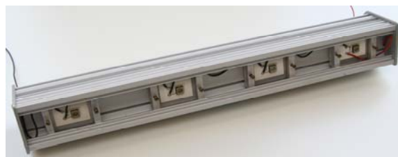
Rys.2. Praktyczna realizacja systemu promieniowania bazującego na diodach UV-C LED typu NCSU334A.
