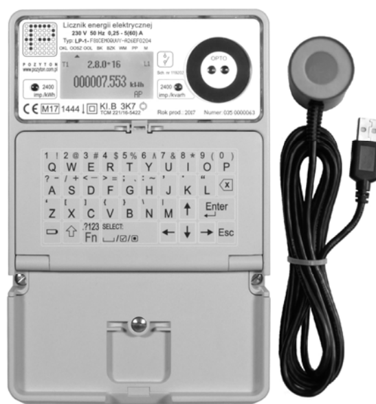
Rys.1 Licznik wyposażony w interfejs optyczny oraz głowica odczytowa z interfejsem USB.
