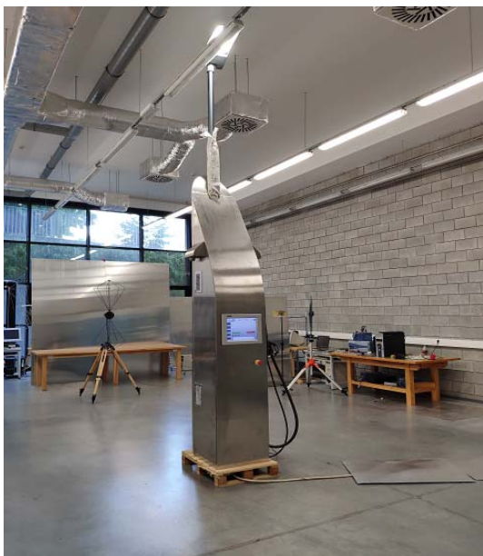
Rys. 1. Prototypowa stacja dwukierunkowego szybkiego transferu energii pomiędzy siecią elektroenergetyczną a pojazdem elektrycznym
