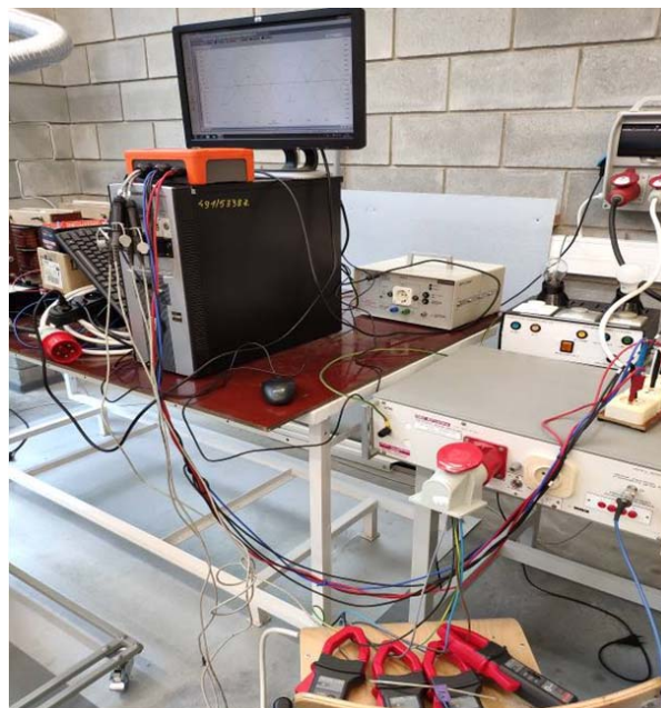
Rys. 3. Widok stanowiska laboratoryjnego do pomiaru parametrów jakości energii
