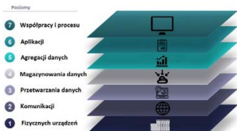
Rys. 1. Model warstwowej architektury systemów IoT (na podstawie [10])
