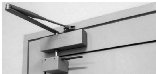
Rys. 6. Elektromechaniczny harvester energii zamontowany bezpośrednio na samozamykaczu drzwi
