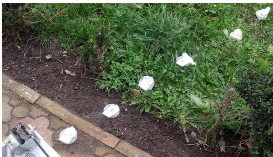
Rys.. 3. Instalacja doświadczalna do zaprawiania nasion pszenicy ozimej polem elektromagnetycznym wysokiej częstotliwości w odległości 25... 175 cm
