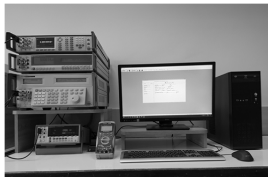
Rys. 1. Stanowisko do wzorcowania multimetrów cyfrowych
