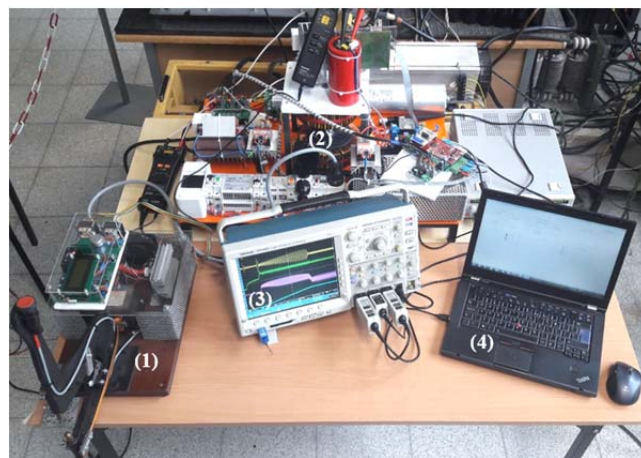
Rys. 7. Widok zrealizowanego stanowiska badawczego: (1)- obciążenie - zgrzewarka; (2)- filtr aktywny z dodatkowym zasobnikiem energii; (3)- oscyloskop TEK DPO4054; (4)- komputer z graficznym interfejsem użytkownika GUI
