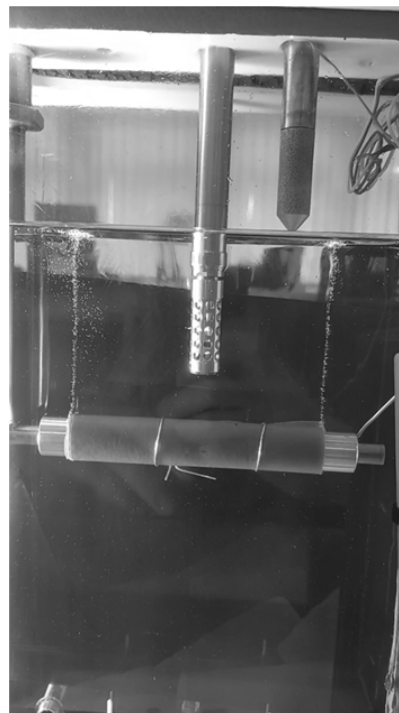
Rys.2. Fotografia próbki zanurzonej w cieczy w naczyniu badawczym w trakcie trwania zjawiska bąbelkowania
