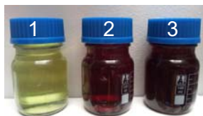
Rys.5. Próbkę estru naturalnego niemodyfikowanego (1) oraz modyfikowanego fulerenem, po zakończeniu procesu jego rozpuszczania, odpowiednio dla stężenia 250 mg/L (2) i 500 mg/L (3)
