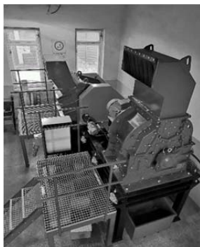
Rys.1. linia technologiczna wieloetapowej obróbki odpadu kompozytowego
