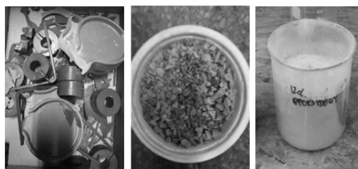
Rys.2. Strumień recyklatu otrzymanego z izolatorów kompozytowych elektrotechnicznych
