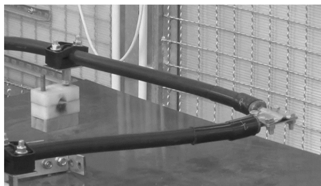
Rys. 5. Przewody w izolacji wysokonapięciowej podczas prób na zgodność z PN-EN 62561-1
