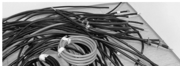
Rys. 4. Przewody w izolacji wysokonapięciowej poddane badaniom
