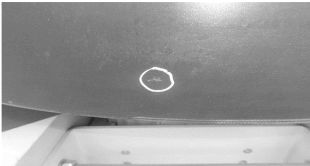
Rys.1. Przykładowy defekt struktury izolacji na powierzchni zewnętrznej cewki WN.
