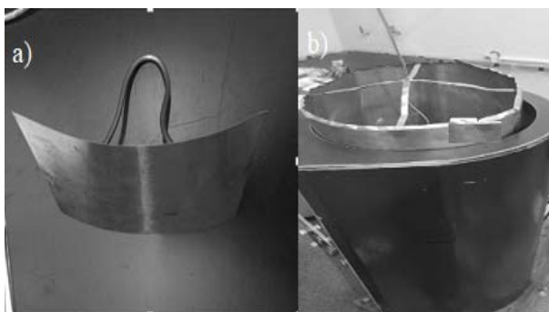
Rys.3. Wygląd elektrod pomiarowych a) płaska, b) cylindryczna.
