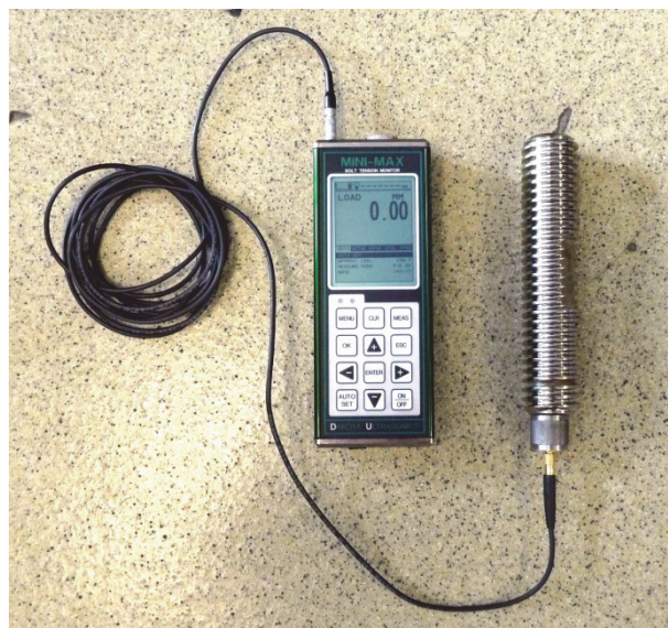
Rys.4. Ultradźwiękowe urządzenie do pomiaru wydłużenia śruby
