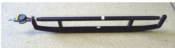
Rys.3. Mechaniczne urządzenie do pomiaru wydłużenia śruby
