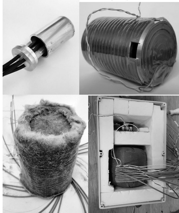
Rys. 2. Etapy budowy zestawu kondensatorów (u góry od lewej: obudowa ekranowana z pojedynczym kondensatorem i obudowa zestawu z folią grzewczą, u dołu od lewej: zestaw pięciu kondensatorów umieszczony w termostatyzowanej obudowie termicznie izolowanej aerożelem. Z prawej strony widoczny wzorzec bez górnej pokrywy obudowy)
