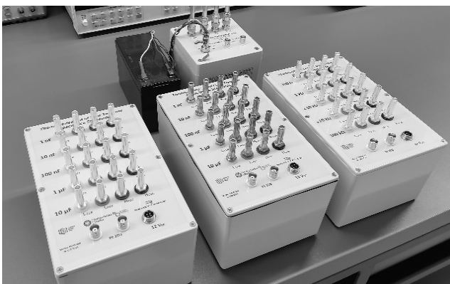
Rys. 1. Zestawy czteroportowych termostatyzowanych kondensatorów wzorcowych: w górnym rzędzie widoczny jest kondensator 10 nF KC0G-10nF, w dolnym od lewej: kondensatory KC0G-1XF L52-1/20, KC0G-1XF L52-2/21 i czteroportowy wzorzec rezystancji Vishay
