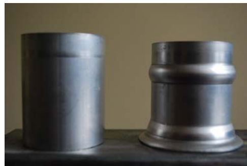
Rys.2. Detal przed i po operacji rozpęczania
