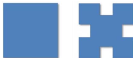
Rys. 3. Inicjator (rys. lewy) oraz pierwsza iteracja fraktala Minkowskiego
