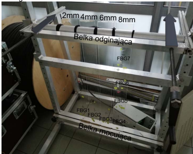
Rys.3. Stanowisko do odkształcania próbek z czujnikami światłowodowymi.
