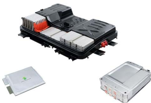
Rys.1. Wygląd zewnętrzny baterii trakcyjnej modułu i ogniwa pochodzących z samochodu elektrycznego Nissan Leaf
