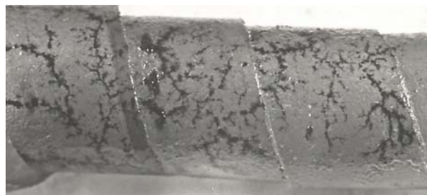
Rys. 6. Ślady wyładowań na powierzchni papieru kablowego.
