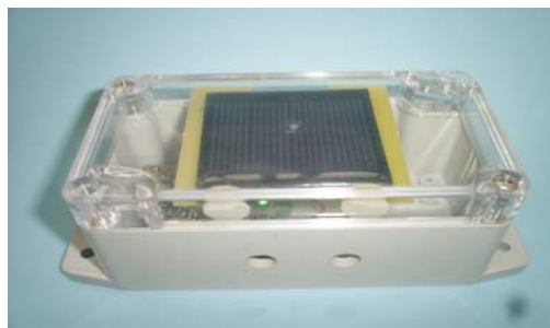
Rys.3. Układ zasilający (harvester) z klasycznym ogniwem fotowoltaicznym.
