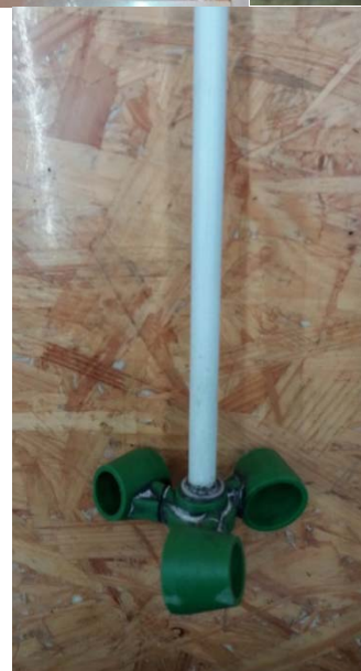
Rys. 2. Widok stanowiska mieszalnika Heidolph RZR 2102 control oraz 0940-Pro 2 z końcówką ViscoJet
