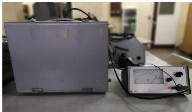
Rys.5. Stánowisko pomiarowe do pomiarów rezystywności skróśnej
