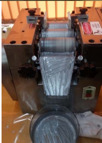
Rys 1. Widok na stanowisko mieszalnika trójwałkowego THREE ROLL MILLS
