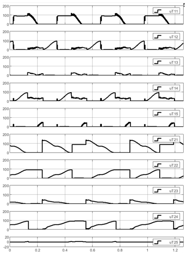
Rys. 3. Napięcia występujące na tranzystorach przekształtnika
