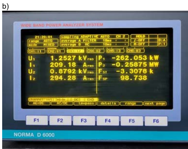
Rys. 8. Oscylogramy napięcia wejściowego i wyjściowego, razem z prądami dławików pracujących w nominalnym punkcie pracy 260 kW, f_s=20 kHz (a), zrzut ekranu z analizatora mocy (b).
