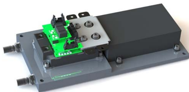
Rys. 6. Moduł mocy MSM450FS33ALT zamontowany na dedykowanym radiatorze razem z kondensatorem obwodu pośredniczącego DC oraz sterownikiem bramkowym.
