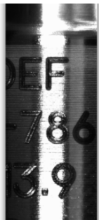
Rys. 1. Treść oznaczenia stempla niemożliwa do odczytania pomimo prawidłowego oświetlenia
