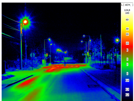
Rys.6. Zdjęcie rozkładu luminancji wykonane cyfrowym miernikiem luminancji LMK - zjazd.
