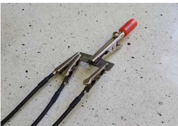
Rys.2. Badany superkondensator z elektrolitem zawierającym sól LiClO 4 oraz elektrodami zawierającymi polipirol [5]
