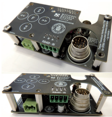
Rys. 9. Zdjęcia autorskiego interfejsu momentomierza Futek dolną (analogową). Górna płyta udostępnia interfejs zdalnego dostępu (RS485), a dolna obsługuje przetwarzanie w torze analogowym z funkcjonalnością:
