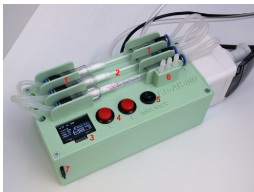
Rys. 2. Widok zewnętrzny urządzenia: 1 – złącza rurek sorpcyjnych, 2 – rurki sorpcyjne, 3 – ekran OLED, 4 – przyciski sterujące, 5 – włącznik, 6 – złączki do mostkowania, 7 – karta pamięci SD wsunięta w czytnik
