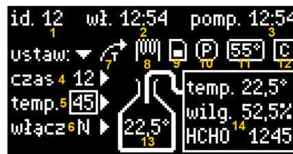
Rys. 4. Ekran użytkownika: 1 – numer serii pomiarowej, 2 – czas od rozpoczęcia pomiarów, 3 – bieżący czas pompowania, 4 – ustawiony czas pompowania albo wybór trybów kalibracji, bądź trybu wykorzystania czujnika elektrochemicznego, 5 – nastawiona temperatura, 6 – rozpoczęcie działania urządzenia, 7 – bieżąca faza pomiarów, 8 – załączenie grzałki, 9 – zapis danych na karcie SD, 10 – załączenie mikropompek, 11 – ostrzeżenie termiczne o grożącym wyłączeniu czujników PMS5003, 12 – informacja o braku odczytu z czujnika PMS5003, 13 – temperatura w stoju, 14 – odczyt z czujnika PMS5003
