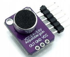
Rys.7. Moduł MAX4466 z regulacją wzmocnienia [5]
