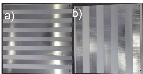
Rys. 2. Płyty PCV maskujące w zakresie mikrofalowym z paskami z folii aluminiowej o szerokości: a) 25 mm, b) 50 mm
