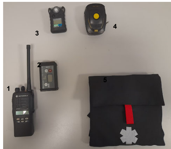
Rys. 3. Zestaw indywidualnego wyposażenia technika kryminalistyki przewidzianego do eksploracji śladów pochodzących z miejsc skażonych czynnikami CBRN: „niezabezpieczony” radiotelefon (1), monitor skażeń promieniotwórczych (2), monitor niskiego stężenia tlenu (3), czujnik bezruchu (4) oraz apteczka pierwszej pomocy (5) [7].
