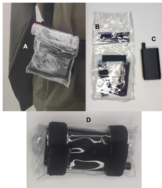
Rys. 4. Widok pokrowca na radiotelefon zaprojektowanego i wykonanego w trakcie realizacji projektu. A – atrapa radiotelefonu w pokrowcu ochronnym na pasie biodrowym noszaka taktycznego, B – otwarty pokrowiec ochronny z widocznymi rzepami poziomymi do zamknięcia pokrowca z radiotelefonem oraz rzepami pionowymi do przymocowania pokrowca do noszaka taktycznego, C – atrapa radiotelefonu Motorola ST7000 (wymiar: 107x60x19 mm), D – zabezpieczony radiotelefon w pokrowcu ochronnym [7].
